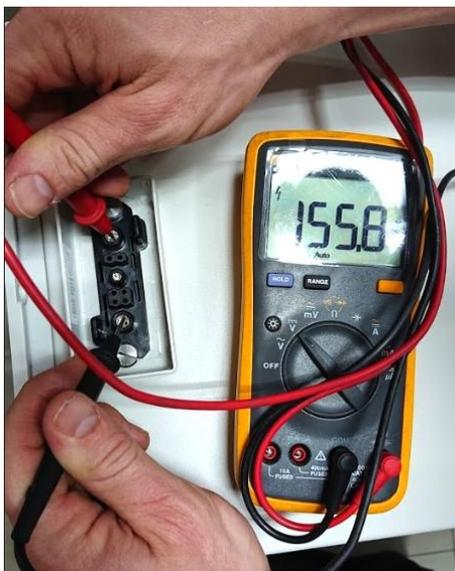
Se la tensione misurata si discosta significativamente dal valore nominale, controllare la tensione dei singoli moduli, come mostrato nella sezione seguente.
